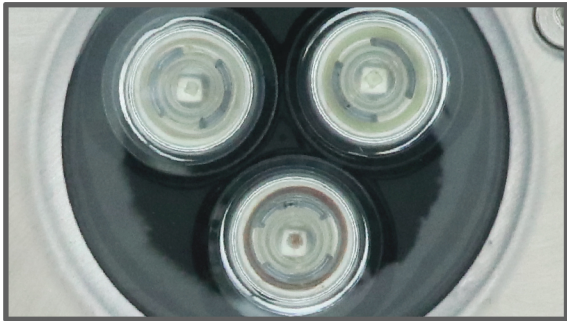
หลอดไฟ LED High Power จำนวน 3 ดวง
